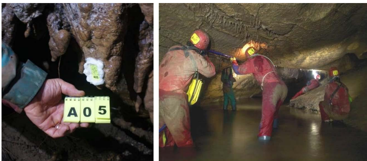
Fig. 6 – Nella foto di destra, una squadra di rilievo al lavoro nell’acqua. Nella foto di sinistra, una delle mire numerate, incollata con schiuma di poliuretano, e il “blocchetto numeratore” utilizzato per visualizzarle nelle foto.
